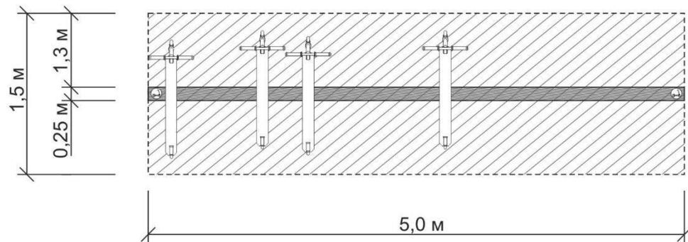
размещение кабель-канала производится по центру
